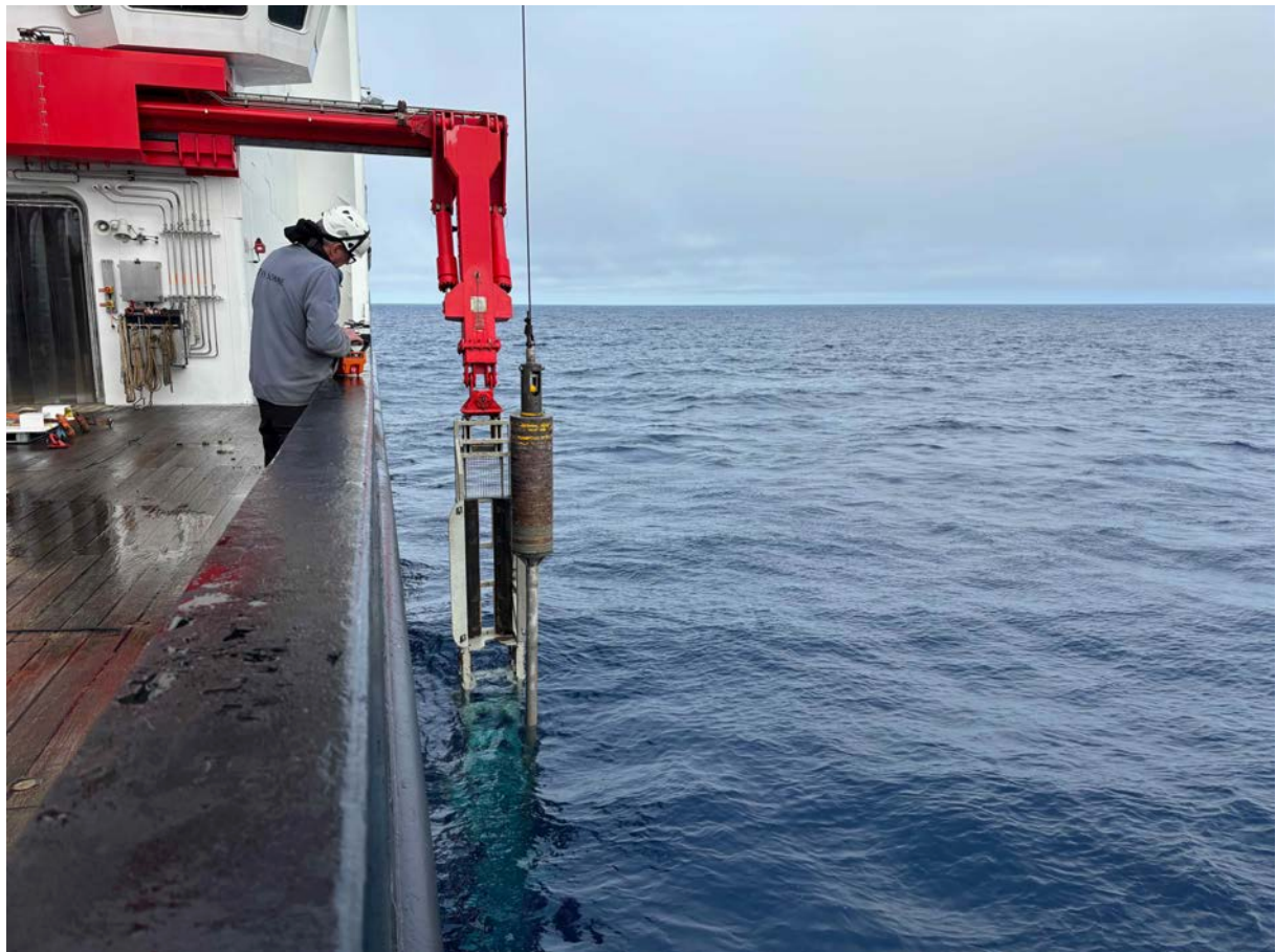
Foto: (Christian Timm): Einholen des Schwerelotkerns mit dem Kernabsatzgestells, welches uns die Möglichkeit gibt bis zum ca.20m lange Sedimentkerne zu entnehmen.
