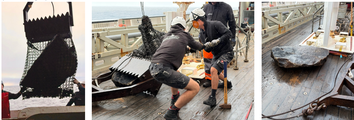
Abb. 3: Dredgezug am mittleren Vance Seamount. Die Probe füllte den Kettensack nahezu vollständig aus und wurde mit Hilfsmitteln durch die Decksmannschaft der SONNE aus dem Kettensack geborgen.
