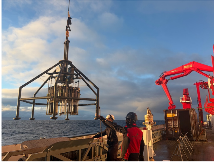
Abb. 2: Bergung des Multicorers (kurz: MUC) nach seinem Einsatz auf der Flanke des Juan-de-Fuca Rückens. Die Probenzylinder sind in der Mitte des Gerätes zu erkennen und mit Sedimenten vom Meeresboden gefüllt.
