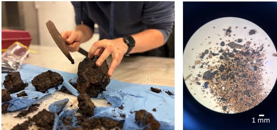
Abb. 4: Mit einer Dredge vom Meeresboden geborgene Gesteinsproben werden für weitere Analysen im Labor vorbereitet (links). T-SECTOR ist ein ERC-Synergy-Projekt, in dem Forschende verschiedener Fachrichtungen gemeinsam an übergreifenden wissenschaftlichen Fragestellungen arbeiten. Entsprechend arbeiten auch in den Laboren der SONNE Forschende aus Geochemie, Petrologie, Paläo-Ozeanographie und Geophysik eng zusammen. Das rechte Bild zeigt Material aus dem Schwerelotkern GC55 unter dem Mikroskop. Zu erkennen sind vulkanische Gläser (schwarz und glänzend), Foraminiferen (weiß), alterierte Gesteine und Basalt (dunkle Partikel) sowie terrigenes Sediment (beige bis sandfarben).
