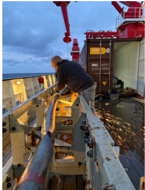
Abb. 3: Das Schwerelot wurde beim Aufprall auf eine harte Zwischenschicht derart verbogen, dass es von den Forschenden aufgrund seiner charakteristischen Krümmung liebevoll als ‚Banane‘ bezeichnet wird.
