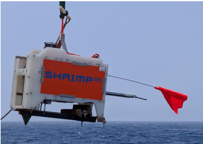
Abbildung 2 - SHRIMP Ozeanbodenseismometer der neuesten Generation für aktive seismische Experiment. Das kompakte Gerät verdriftet daher beim Absinken weniger in der Wassersäule. Geophon und Hydrophon sitzen geschützt im Rahmen und die Schwimmlleine kann eingeklemmt werden und wird erst beim Aufsteigen mit befreit. (Foto A. Dannowski).
