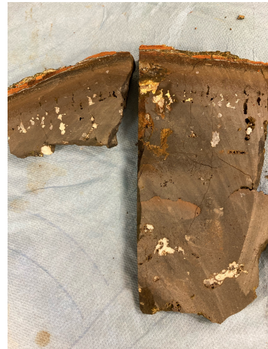
Abb. 2 a (links): Einsammeln der geborgenen Gesteine aus der Dredge während der Nachtschicht. 2 b (mitte): Wissenschaftlerin beim Sägen der Gesteinsproben. 2 c (rechts): Gesägte Scheiben aus Kissenlava (DR33). Zu erkennen sind die teils weißlich verfüllten, teils offenen (schwarzen) länglichen Blasen Hohlräume, die entstehen wenn im Magma gelöste Gase vor der endgültigen Erstarrung der Lava noch nach außen (oben) streben. Die Abschreckungskruste bildet einen schwarz/orangen Saum (aus teilweise frischem und verwitterten vulkanischem Glas) (Fotos: J.G.).
