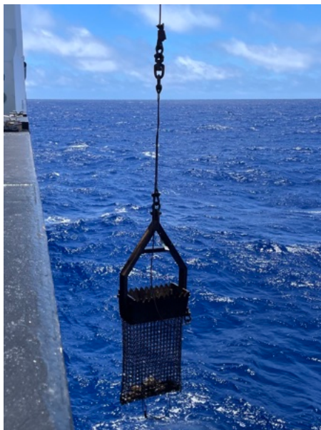
Abb. 1: Eine Kettensackdredge kommt zurück an Deck der SONNE (Foto: H. von Drenkmann.)
