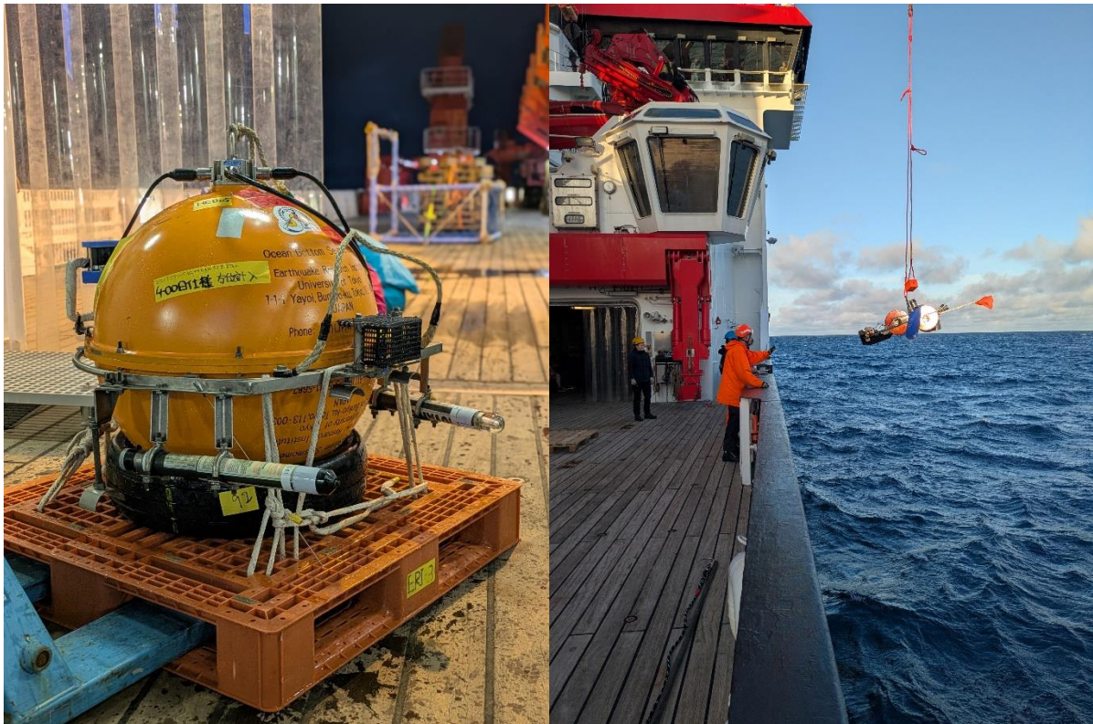
Links: Ein japanisches Ocean Bottom Seismometer nach dem Einholen im Hangar, Rechts: Ein deutsches Seismometer wird an Bord geholt. Copyright Max Moorkamp
