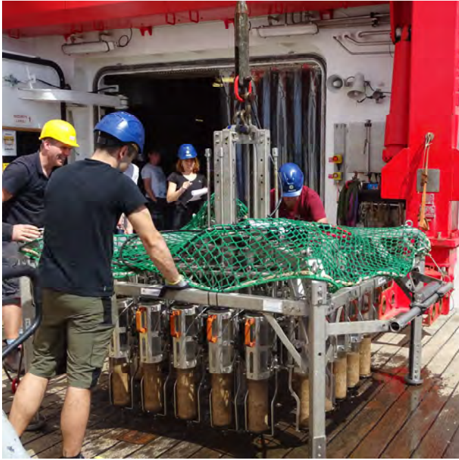
Links: Ein videogestützter 20-Kern-Multicorer bringt kurze Sedimentkerne vom Meeresboden an Deck des Schiffes (Foto: Simone Sturm). Rechts: Labortechniker René Herbst verarbeitet geochemische Proben aus dem Multicorer im Kühllabor (Foto: Robert Sommerfeldt).
