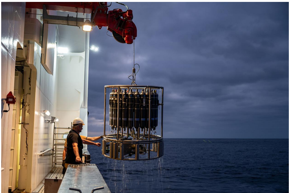
Die CTD-Sonde mit Wasserkransschöpfer wird nach einem erfolgreichen Einsatz an Bord gehievt (Foto: V. Diekamp).
