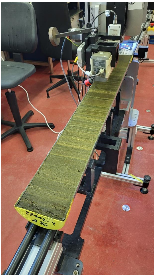
Links: Dokumentation eines Sedimentkerns mit dem Multi-Sensor Core Logger. Rechts: Das Schwerelot mit einen Sedimentkern wird an Bord gehievt (Fotos: P. Grunert).
