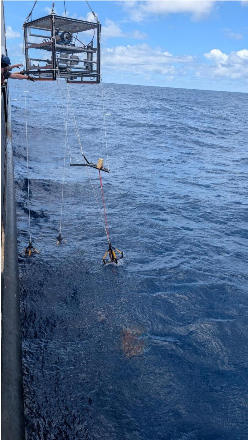
**Abb. 1: Bergung des nicht ausgelösten roten OBS (gerade noch unter Wasser) unterhalb des Videoschlittens OFOS. Unterhalb des OFOS sind die drei Dragen und der Y-förmige Rahmen zu sehen, mit dem das OBS schlussendlich an seinem gelben Schwimmkörper in 3000 m Wassertiefe aufgenommen werden konnte.**
