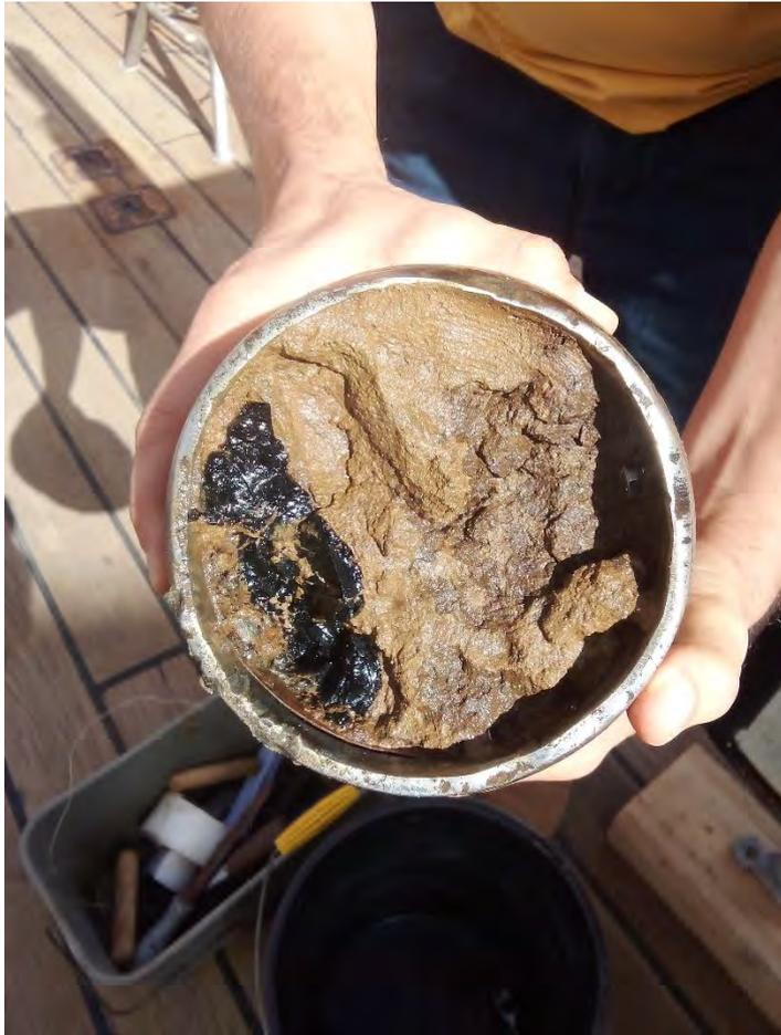
**Abb. 3: Sedimentkern, der im Core Catcher ein großes basaltisches Glasfragment enthält, das belegt, dass der Kern die Sedimente komplett durchteufte und die basaltische Ozeankruste erreichte.**
