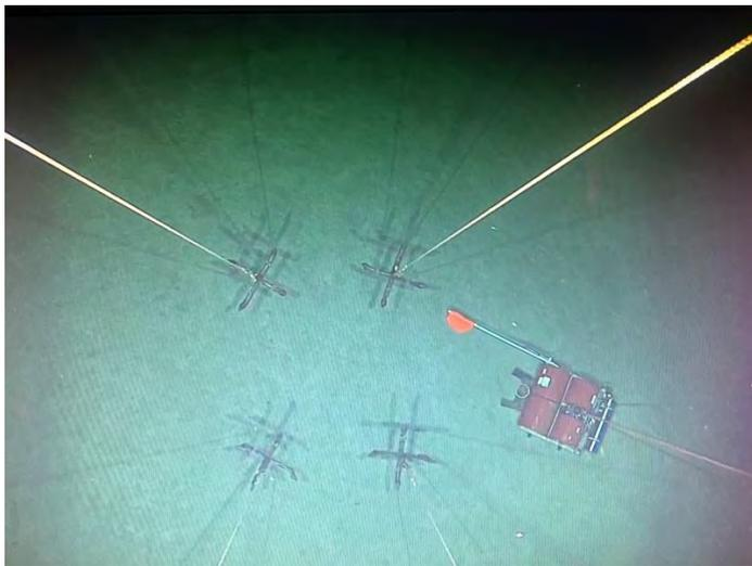
Abb. 2: Blick auf die vier Draggern unterhalb des Videoschlittens OFOS, die zur Bergung des OBS, das nicht ausgelöst werden konnte (rechts im Bild), eingesetzt wurden.
