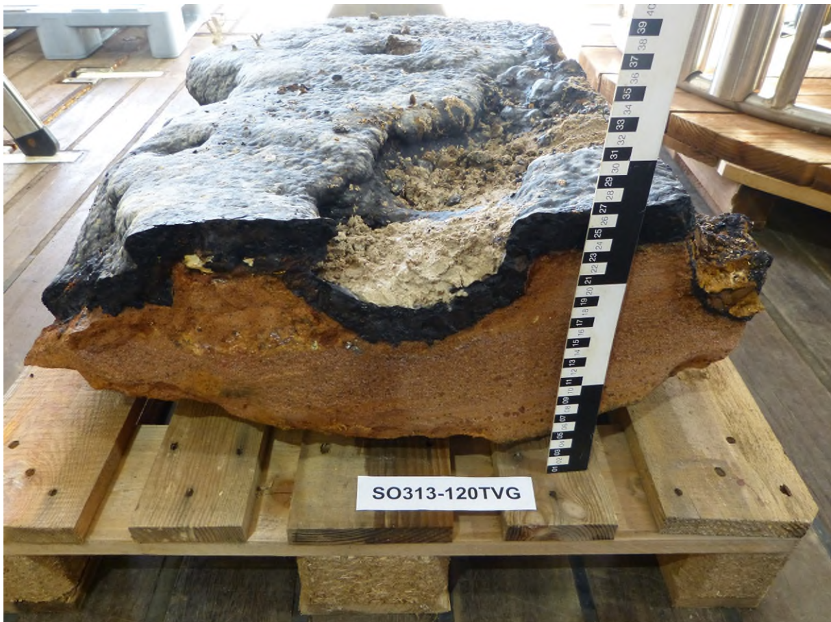
Abbildung 1: Eisen-Mangan-Krusten auf „vulkanischem Sandstein“ vom Seamount 420. Bei dem lagigen vulkanischen Sandstein handelt es sich wahrscheinlich um Aschelagen, die submarin umgelagert wurden. Die Probe hat die Maße 110 x 80 x 25 cm und wiegt ca. 120 kg. Foto: S. Sturm.
