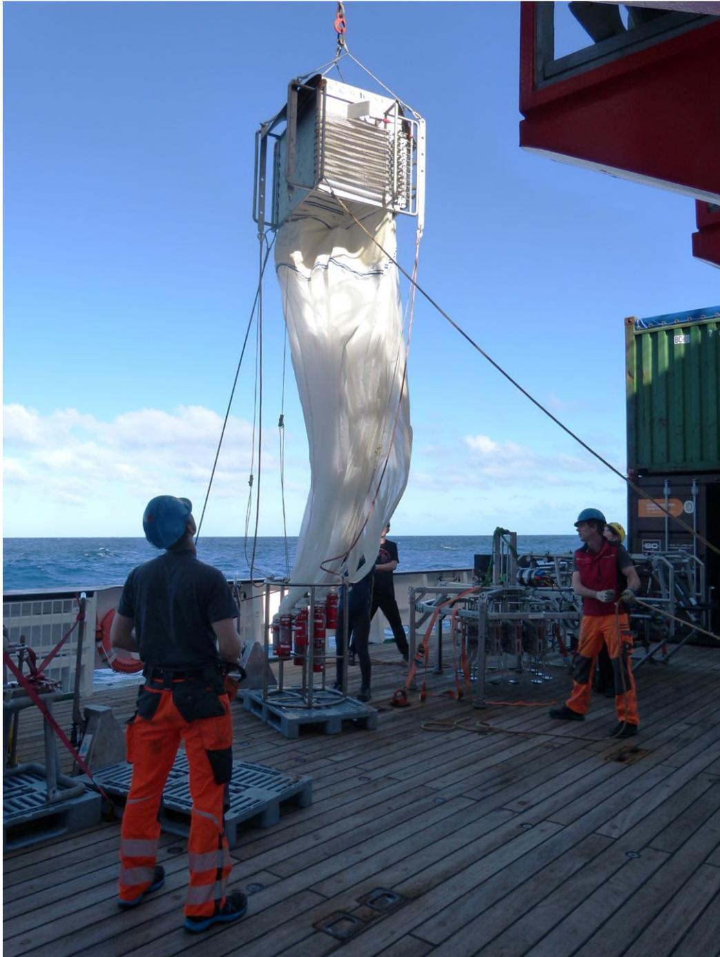
Vorbereitung des Multinetzes für den Einsatz während der SO313 (Foto: S. Sturm).
