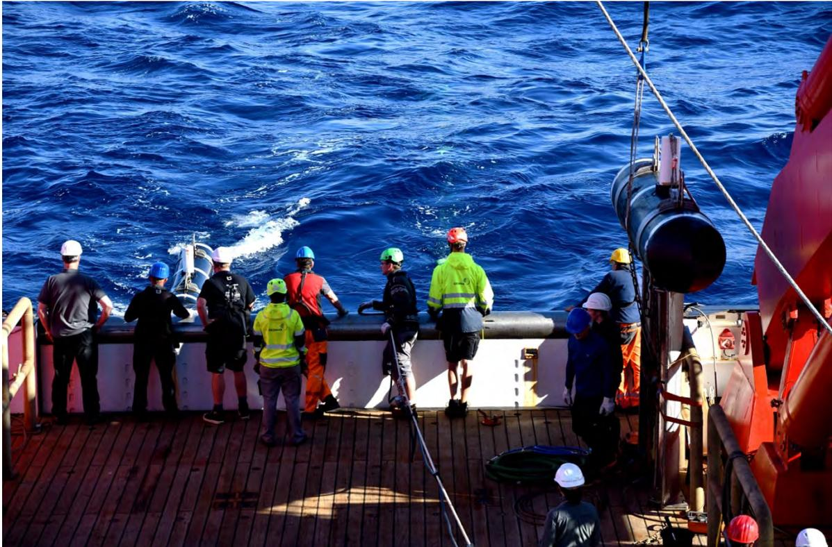
*Abbildung 2: Ausbringung des 3D-Seismiksystems mit dem Backbord-Scherbrett im Wasser und dem Steuerbord-Scherbrett noch an Deck. Foto: Aude Lavayssiere.*
