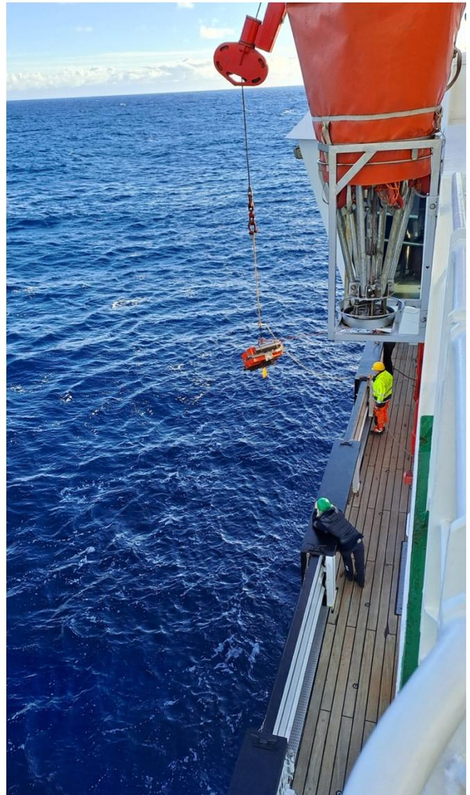
Abbildung1 Einsatz des Ozeanboden-Seismometers. Foto von Ines Staben.
