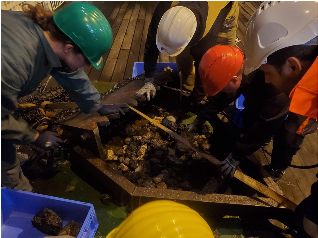
Abb. 3: Der Inhalt einer Kettensackdredsche wird von Forschenden der FAU Erlangen-Nürnberg erwartungsvoll inspiziert. Solche Proben des weiteren Umfelds der Vulkane erlauben Rückschlüsse auf Magmenherkunft und -Entwicklung in der Region. Foto: Fabian Hampel
