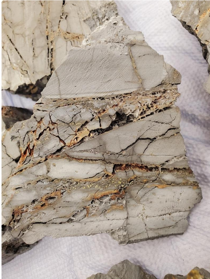
Abb. 2: Eindruckvolle Proben von Stockwerksvererzungen konnten mit dem TV-Greifer geborgen werden. Foto: Fabian Hampel
