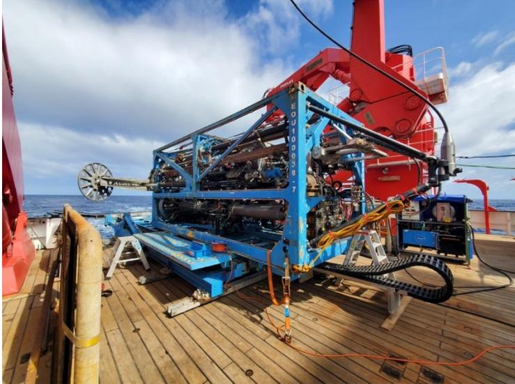
*Abb. 2: Das Meeresbohrgerät MeBo200 wird auf dem Arbeitsdeck der SONNE auf den ersten Einsatz vorbereitet.*
