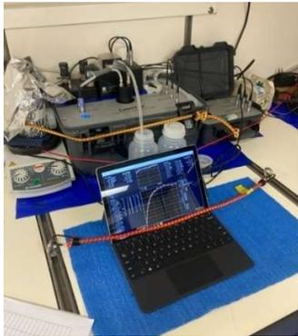
Ein spezielles Fluorometer zur Abschätzung der potentiellen Primärproduktion des Phytoplanktons bei verschiedenen Lichtintensitäten.
