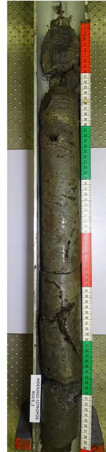
Abbildung 1: ROV ROPOS mit angebauten Bohrgerät ROCS (links, Foto: T. Kuhn) und mit ROCS gewonnener Bohrkern aus dem AURORA-Feld (Foto: S. Sturm).
