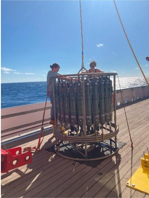
Abbildung 2: Einrichten der CTD für die Spurenelemente bei Tageslicht.
