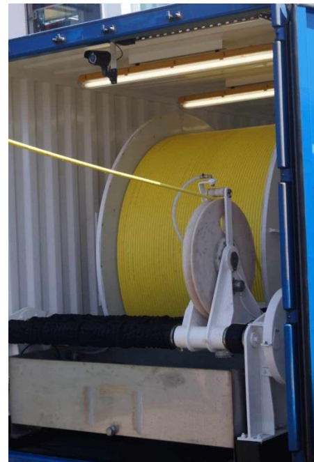
Abb. 3: Oben: Winde mit Kevlar-Draht. Unten: Einsatz des Titan-CTD-Rahmens. Foto E Achterberg (oben) und C. Rohleder (unten)
