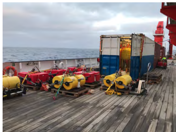
Abbildung 1: Zur Installation vorbereitete OBS vor dem OBH Container.
