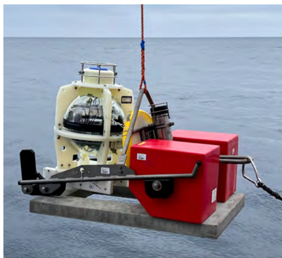
Abbildung 4: Schwimmtest des driftfreien Drucksensors auf einem modifizierten OBS Geräteträger. Photo: T. Bartels.
