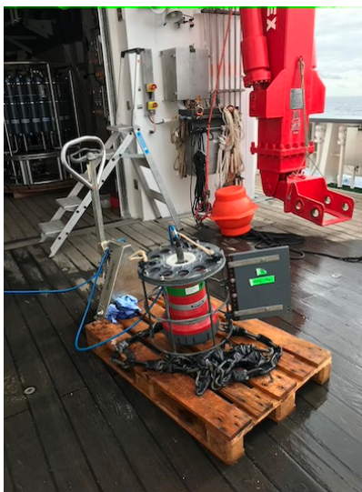
Abbildung 4: Akustisches Modem zum Auslesen der Drucksensoren. Photo: D. Lange
