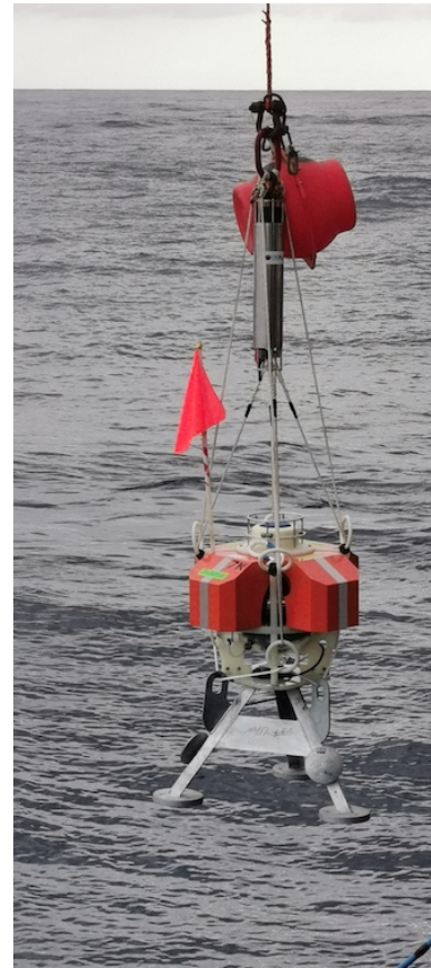
Abbildung 3: Drucksensor während des Absetzens am Tiefseedraht. Photo: A. Dannowski.
