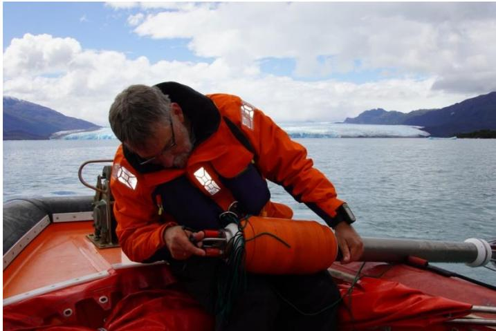
*Abbildung 4: Toralf Heene bereitet die Speicher-MSS im Arbeitsboot für die Messung vor. Im Hintergrund ist die Gletscherzunge sichtbar.*
