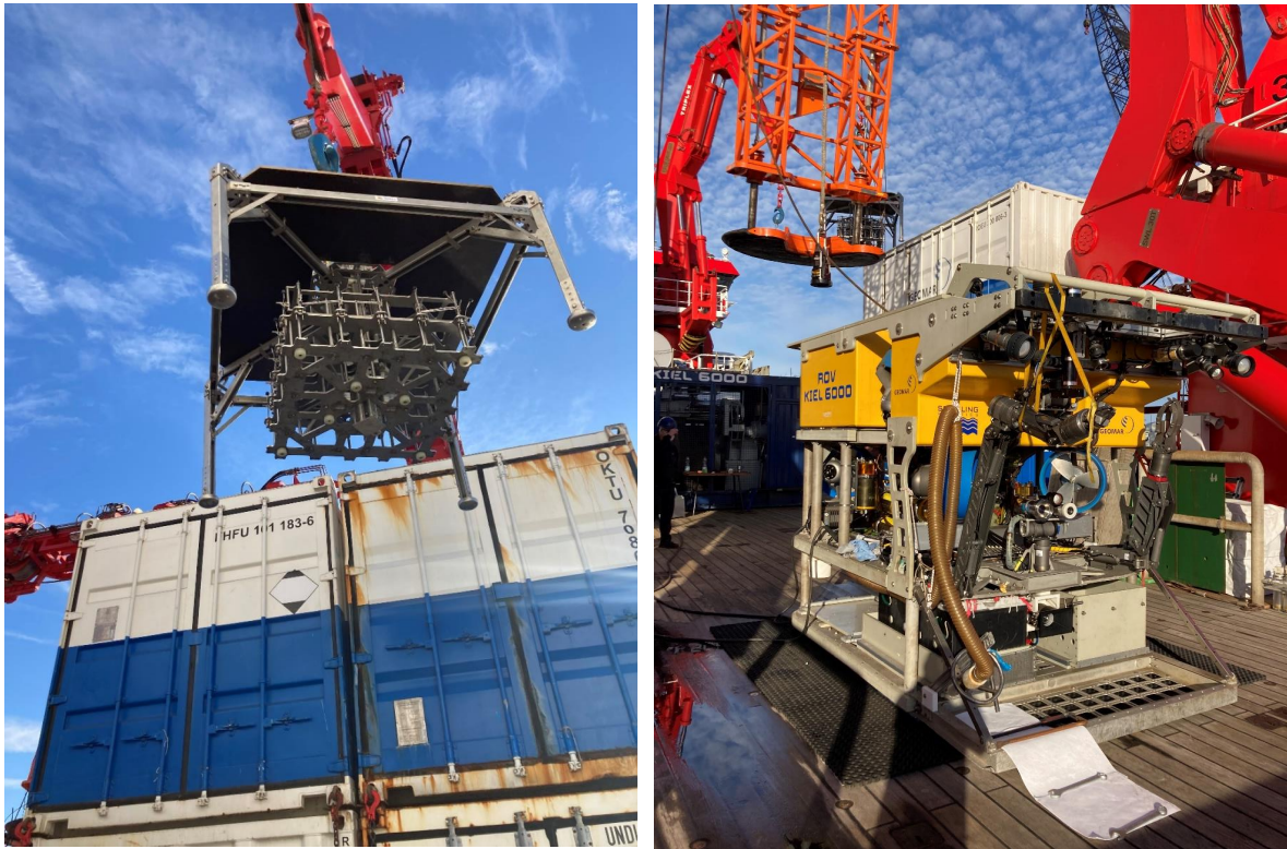
Abb.2: Links: Der Multicorer wird mit dem Kran auf seine Position an Deck gesetzt. Rechts: Das ROV KIEL 6000 wird geprüft.
