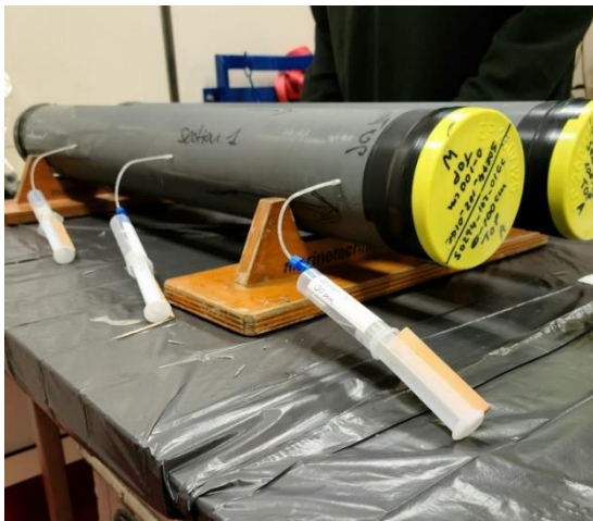
Abbildung 5: (a) Einsatz des Schwerelotes bei Station SO294_102. (b) Aufnahme bei der Kernentnahme an Deck, v.l.n.r.: Lea Rohde, GEOMAR, Wanda Schmitz, Universität Hamburg (Photo: Sarah-Marie Kröger, Christian Albrechts Univ. Kiel).
