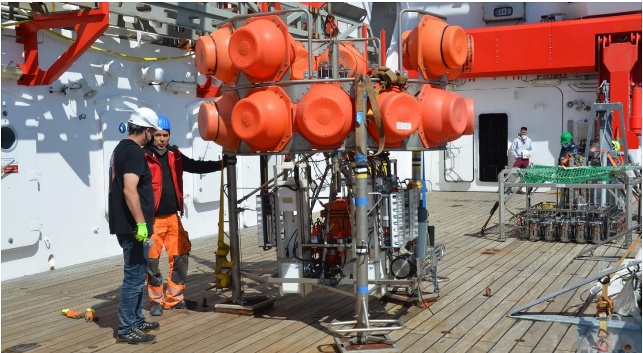
Abbildung 5: Freifall-Landersystem an Bord des FS Sonne vor dem Einsatz.
