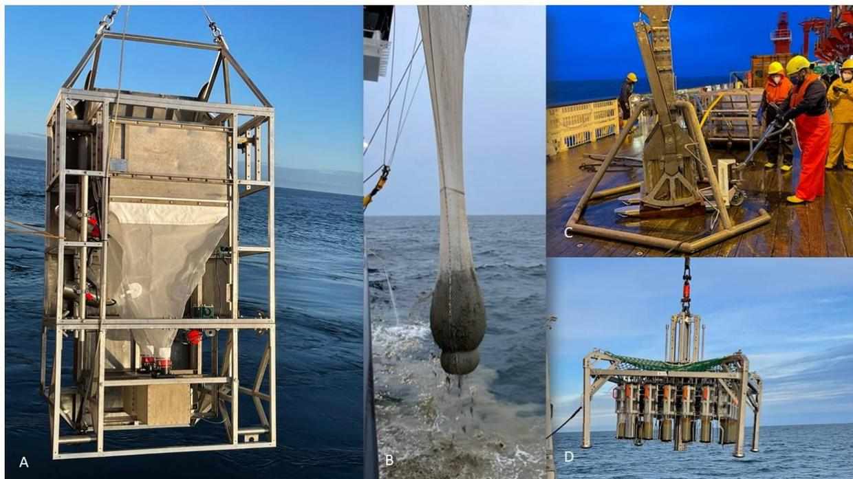
Abbildung 3: Benthosgeräte A Epibenthosschlitten, B Agassiz Trawl, C Großkastengreifer, D Multicorer.
