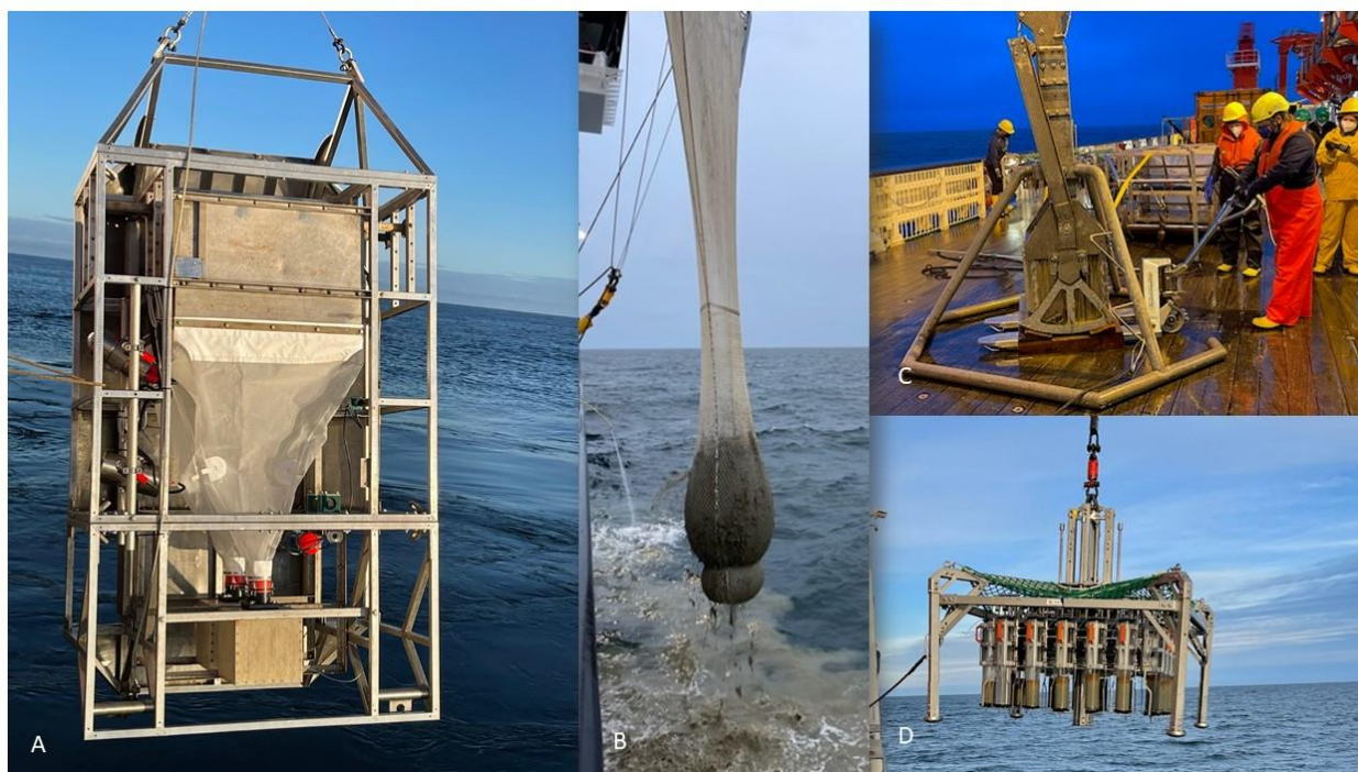
Abbildung 3: Benthosgeräte A Epibenthosschlitten, B Agassiz Trawl, C Großkastengreifer, D Multicorer.
