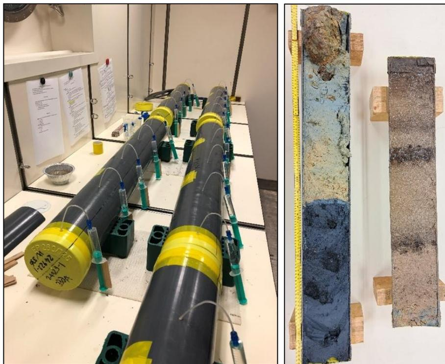
Abbildung 2: i) Rhizone, die Porenwasser aus einem Sedimentkern entnehmen; und ii) ein aufgespaltener Sedimentkern, der das Auftreten eines Serpentin-Schlammstroms zeigt und bereit zur Beschreibung ist.
