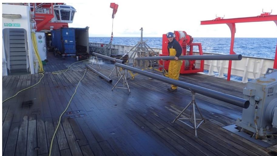
Abb. 3: Jelle Nürnberg bereitet die "Liner" für den Einsatz des Schwerlotes vor. (Foto: SO290, S. Plewe, CC BY 4.0).
