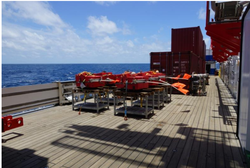
Abb. 1: Verwaistes Arbeitsdeck während FS SONNE SO288. Im Vordergrund sind die Ozeanbodenseismometer zu erkennen, die für ihren Einsatz in Wassertiefen bis 6000 m vorbereitet sind.
