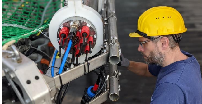
Abbildung 3. Alexander Kieneke (Senckenberg am Meer) überprüft die OFOS-Kamera, die auf dem 20-Kern-Multicorer montiert ist. Als „TV-MUC“ eingesetzt, konnten wir in unserem Arbeitsgebiet, das geologisch als Ausbreitungsschneise westlich des MAR charakterisiert ist, weiches Sediment auf der Spitze des Seamount beproben. Foto © Viola Siegler, Senckenberg am Meer
