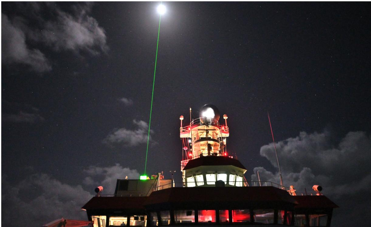
*Abbildung 1 Nachtansicht des 532-nm-Laserstrahls des PollyXT-Lidars, das während der Fahrt SO284 auf dem FS Sonne installiert ist. Das Lidar misst Profile der atmosphärischen Feuchtigkeit und der Aerosole.*
