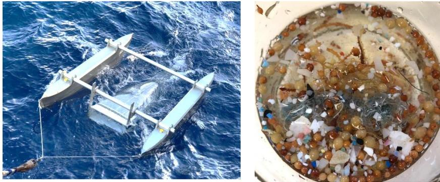
Abb. 1. Links: Katamaran Schleppnetz, welches Partikel aus den ersten 30 cm der Wasseroberfläche sammelt. Rechts: Eine typische Probe aus dem Katamaran Schleppnetz mit vielen bunten Plastikpartikeln. Die kleinen braunen Kugeln sind Luftkammern die von der Alge Sargassum stammen. (© U. Panknin/GEOMAR)
