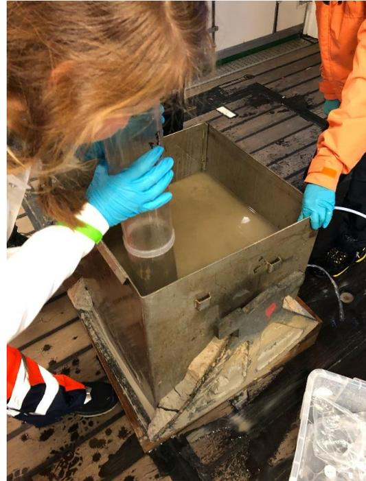
Abb. 3. Das Sediment Team nimmt Unterproben vom Sedimentkasten. © I. Schulz/GEOMAR
