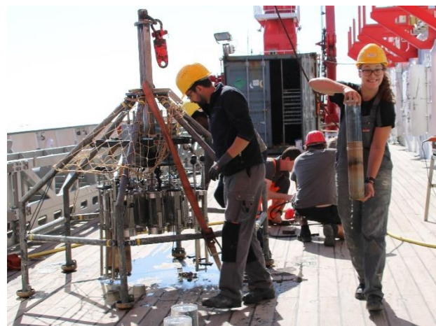
Abbildung 2: Neben anderen Beprobungsgeräten ist der Multicorer auf dem Arbeitsdeck immer präsent. Mit ihm werden die obersten 50 cm des Meeresbodens relativ störungsfrei beprobt. (© Julia Krahl).
