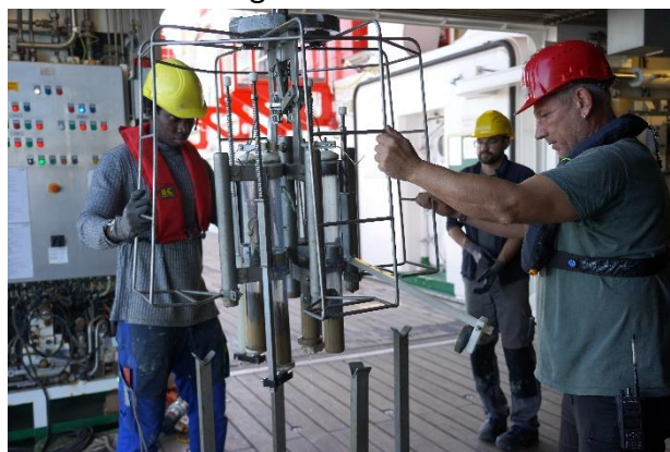
Abbildung 4: Der Minicorer, ein sehr einfaches Instrument zur Probennahme von exakten Meeresbodenproben mit Bodenwasser, wird auf dem Schiff in Empfang genommen (© Tabea König).
