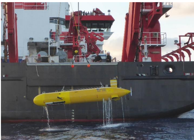
Abbildung 1: Das MARUM AUV Seal 5000 wird nach seiner 13-stündigen Tauchfahrt in 2000 m Wassertiefe über den A-Rahmen an Bord der SONNE gehievt (© Till von Wahl).
