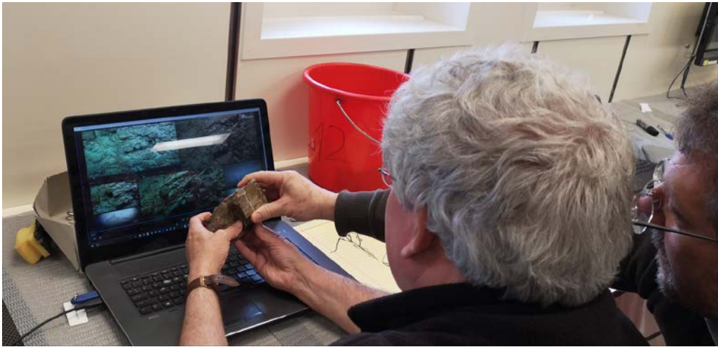
Mike Cheadle (Wyoming University, links) und Daniele Brunelli (Universität Modena, rechts) beim Übertragen von Strukturdaten vom Aufschluss auf jene orientierte Proben, die mit dem Bremer ROV "Quest" (Remotely Operated Vehicle) genommen wurden. Dazu ist es notwendig, das Video des entsprechenden Tauchganges genau zu analysieren. Foto: J. Koepke.
