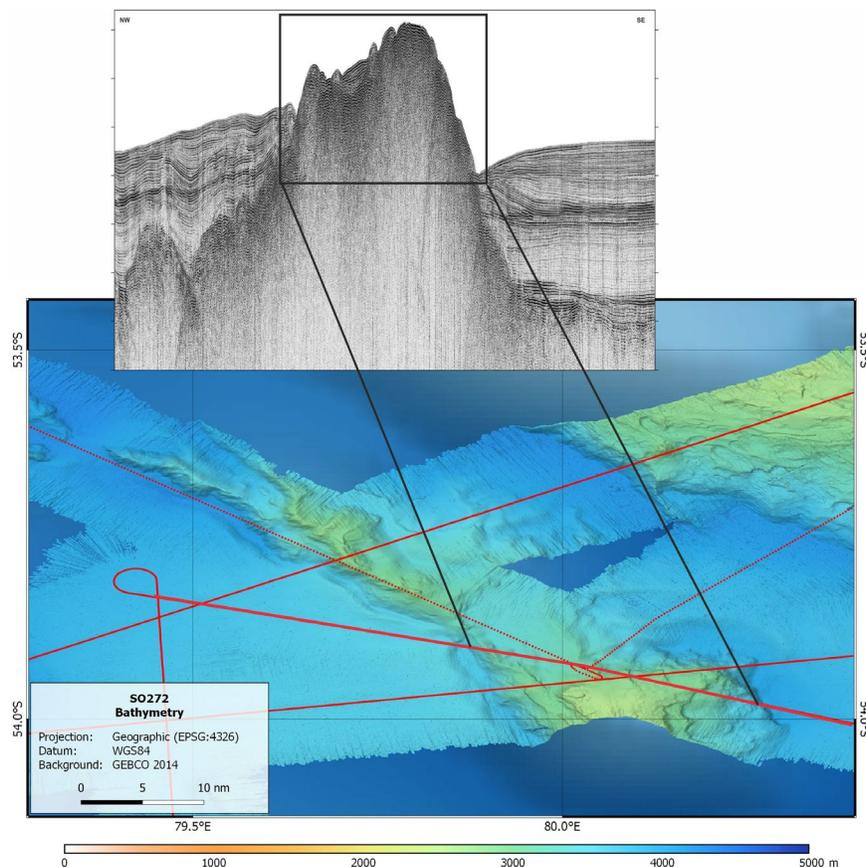
des Meeresbodens. Diese Information hilft uns in der Beurteilung, ob die Strukturen, welche wir seismisch abbilden, eher kleinräumig sind oder ob es sich um langgestreckte Strukturen handelt. In der Abbildung sehen wir im seismischen Profil einen Hügel. Die bathymetrischen Daten zeigen uns die räumliche Struktur und Ausdehnung des Hügels, der in Verbindung mit einem nördlich gelegen Hügel zu stehen scheint. Diese Hügel bestehen aus Hartgestein, sehr wahrscheinlich
