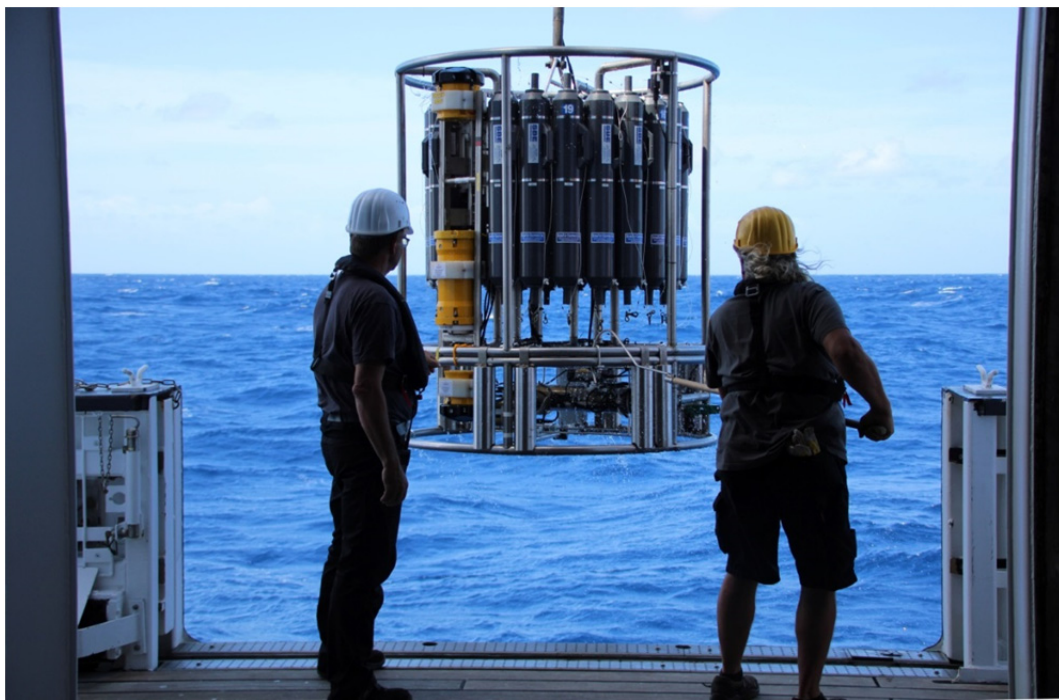
Abb. 2: Aussetzen der CTD und des Rosettenwasserschöpfers während der SONNE Expedition SO270 MASCARA. Foto T. Wasilewski, CEN, Uni Hamburg
