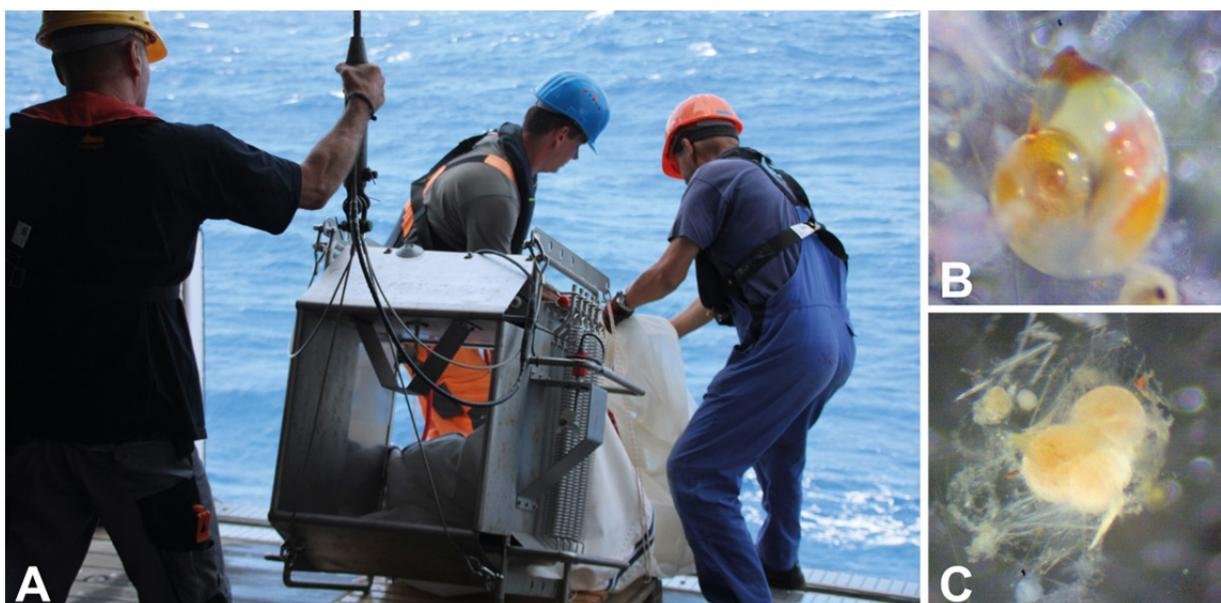
**Abb. 1:** Stationsarbeiten mit dem 100 µm Multischließnetz (multiclosingnet, MCN) sowie erste Planktonproben. **A)** Aussetzen des Gerätes. Foto T. Wasilewski, CEN, Uni Hamburg; **B)** Pteropode (Flügelschnecke); **C)** Planktische Foraminifere *Globigerinoidessacculifer*. Fotos Björn Taphorn, MPIC, Mainz
