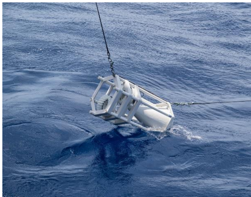
Abb. 1. Verankerungsaufbau (links) und Sinkstofffalle wird ausgesetzt (rechts). Photo R. Prien (IOW).
