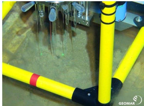
Mikroprofiler zur Messung von Sauerstoffprofilen mit hauchdünnen Glaselektroden im Meeresboden.
