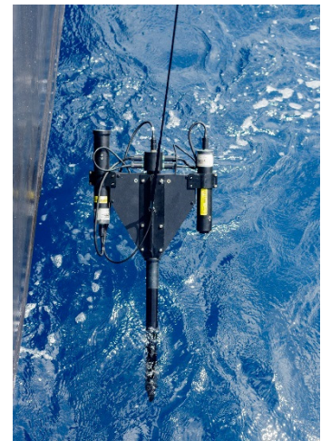
Abb. 4. Satlantic Profiler bei dessen Ausbringung am Heck des FS SONNE (Foto: S. Dörner).
