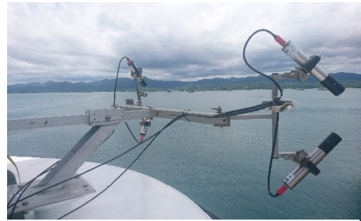
Abb. 1: Radiometer Aufbau, montiert auf dem Schanzkleid der Back des FS SONNE (Foto: D. Voss).
