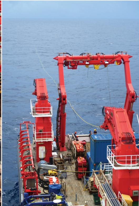
**Links:** Genutzte Gerätschaften während SO-267, dicht gedrängt auf dem Arbeitsdeck: Kettensackdredge, Schwerelot, Wärmestromlanze, ein paar der OBSe und das AUV im Hintergrund.
