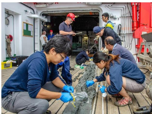
**Abbildung 4:** Wissenschaftler der SONNE-Expedition bei der Beprobung eines Tütenlotes auf dem Arbeitsdeck. Die Nutzung einer Schlauchfolie anstatt eines Plastikliners ermöglicht einen sehr viel schnelleren Zugang zu den Sedimenten nachdem der Kern an Bord gehievt wurde (© Paul Wintersteller).
