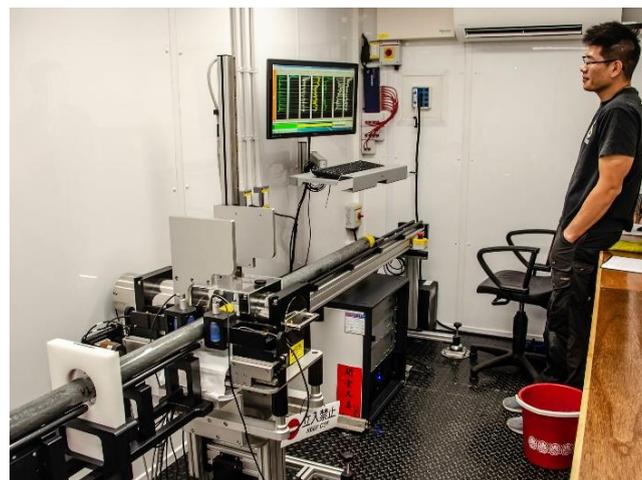
**Abbildung 2:** Bevor die Sedimentkerne der Länge nach aufgetrennt und beprobt werden, werden sie mit dem Multisensor-Kern-Logger im Container vom TORI-Institut aus Taiwan auf ihre physikalischen Eigenschaften hin untersucht (© Paul Wintersteller).
