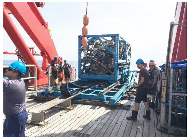
**Abbildung 2:** Nachdem alle Funktionen des MeBo200 und seiner Winde getestet sind, wird das Bohrgerät auf seinem Launching-System nach achtern über die Schiffskante hinausgefahren, bevor es um 90° gedreht zum Meeresboden gefiert wird (© Gerhard Bohrmann).
