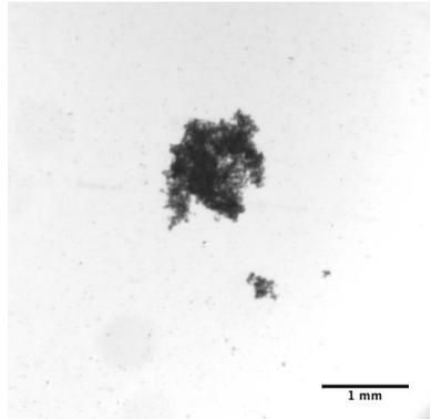
Oben links: Aussetzen des "Marine snow catcher", oben rechts: Versuchsaufbau zur Messung von Partikelgrößen. Unten: Drei "marine snow"-Aggregate, die im Labor bei unterschiedlichen Partikelkonzentrationen erzeugt wurden um einen abbaubedingte Suspension zu simulieren, von links nach rechts: 0 / 17,5 / 35 Milligramm pro Liter. Anhand der beiden rechten Fotos ist erkennbar, dass höhere Partikelkonzentrationen zu kleineren Aggregaten führen.
