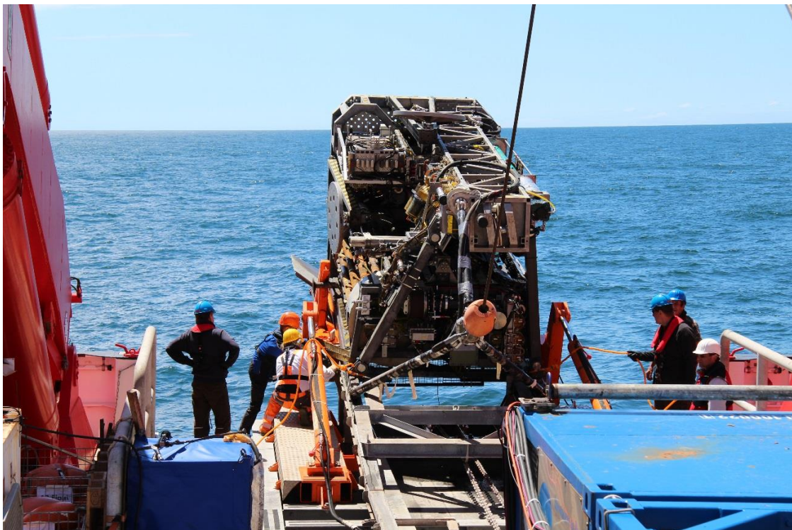
Abbildung 2: Einholen des MeBo70 Bohrgerätes auf dem Achterdeck der SONNE. (Foto: Sabine Kasten)
