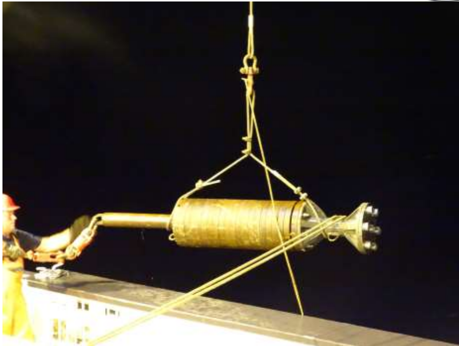
Einsatz des Vulkanitstoßrohres in Cluster 4
